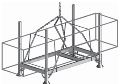
Palette avec anneaux ouverts : levage en panier
