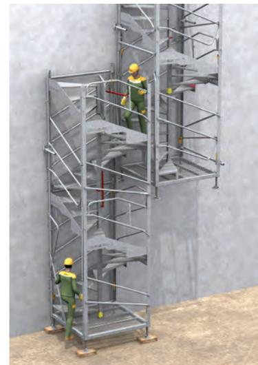
Dans le cas où cette solution n'est pas envisageable, l'accès peut être réalisé avec l'association d'un palier en console et d'un escalier de talus.
