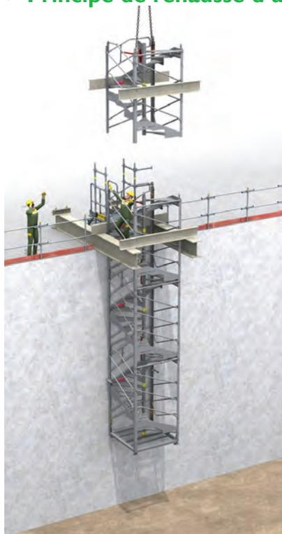
> **1** - Sur le module en place, mettre la lisse de montage en position horizontale et retirer le garde-corps de fermeture. Pose d'un nouveau module préalablement équipé d'un garde-corps de fermeture et des UPN.
