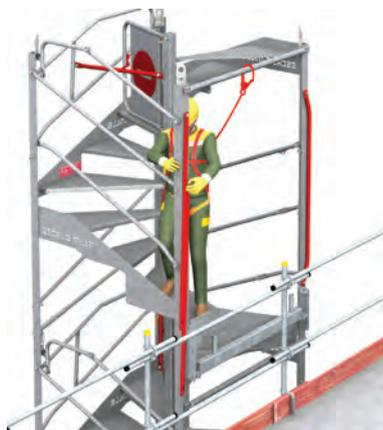
> **2** - Longe accrochée sur le module, basculement des garde-corps pour permettre la mise en place de la passerelle.
