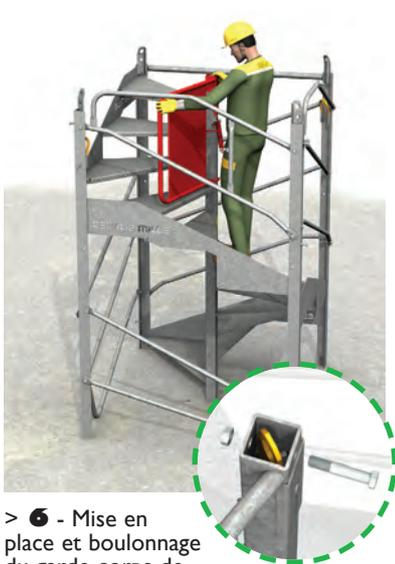
> **6** - Mise en place et boulonnage du garde-corps de fermeture : la lisse de montage est en position horizontale.
