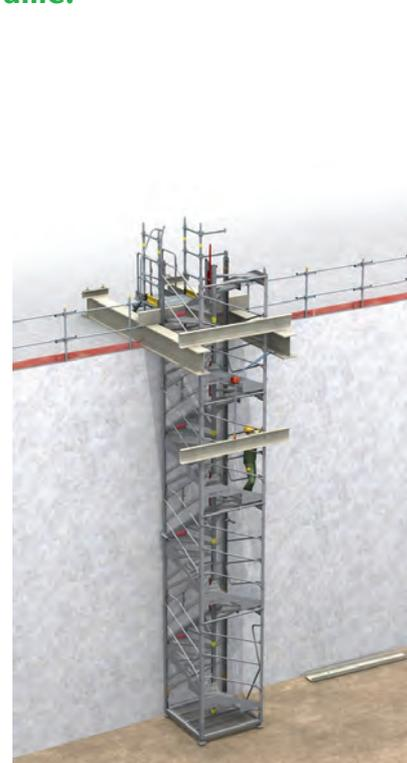
> **3** - Descendre l'Escalib Mills jusqu'à ce que les 2 nouveaux UPN soient en appui sur les HEB. Mise en place des amarrages. Démontage des 2 UPN.
