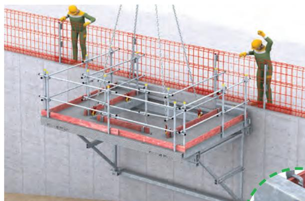
> **4** - Pose de la plateforme sur les attaches volantes. Mise en contact de la vis de butée des bracons contre la paroi. Accéder à la plateforme pour désélinguer. À l'aide de boulons M16-160-8.8, verrouiller la plateforme aux attaches.
