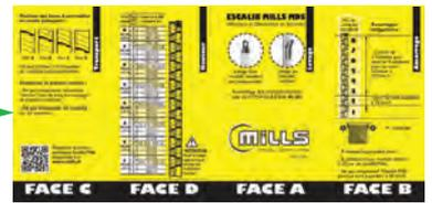
Un autocollant d'information est collé sur les modules et les embases pour définir l'orientation de l'Escalib Mills suivant la hauteur à desservir et rappeler les consignes de montage, de levage, d'amarrage et de transport.
