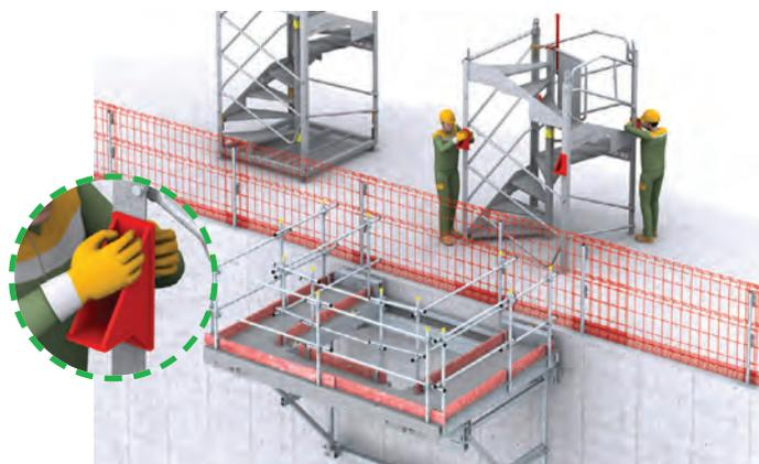
> **5** - Au sol, pose des 4 sabots dans les perçages du module de tête avec les vis M16-35-8.8 (ou des corbeaux pour les sabots réglables). Assembler le module de tête aux autres modules et à l'embase pour lever l'ensemble.
