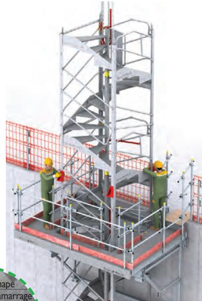
> **3** - Soulever l'Escalib Mills pour retirer les 4 sabots (ou les 4 corbeaux pour les sabots réglables).
