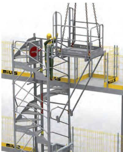
> **4** - Pose de la passerelle latérale sur l'Escalib Mills. Assemblage des bracons sur le 2<sup>ème</sup> Support Passerelle MDS avec les boulons M12-100-8.8. Pose de l'anti-soulèvement et de la passerelle. Désélingage.
