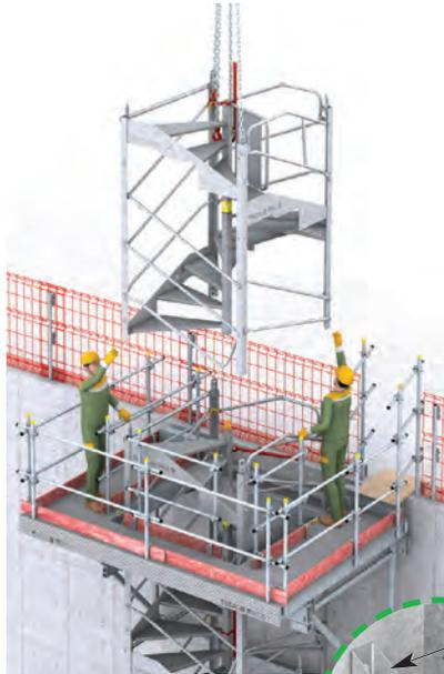
> **2** - Mettre le garde-corps de fermeture sur le nouveau module. Puis l'assembler sur l'Escalib Mills. Déposer provisoirement les colliers des chapes d'amarrage.
