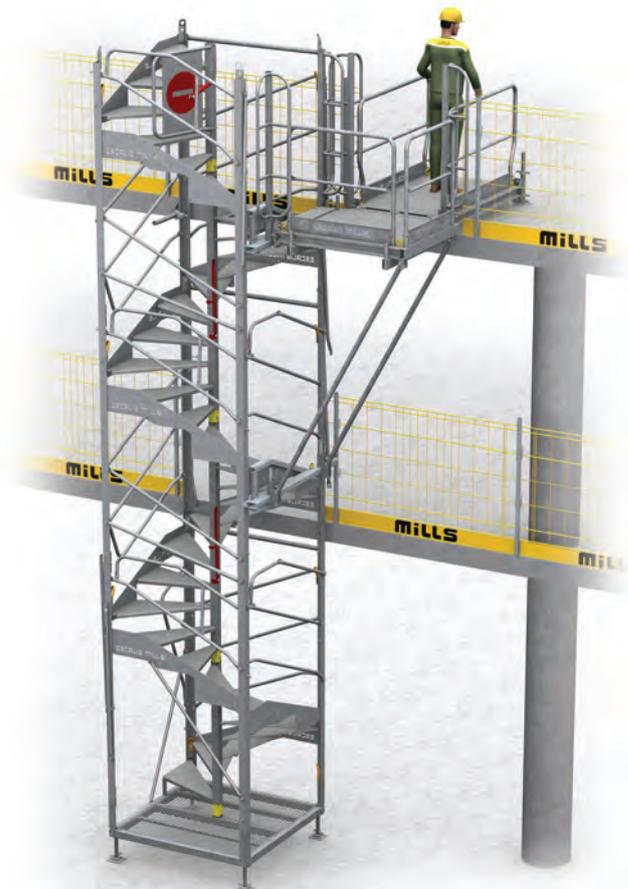
> **5** - Si nécessaire, pose de la passerelle frontale sur la passerelle latérale et boulonnage avec les boulons M12-100-8.8 pour l'anti-soulèvement. Ouverture des garde-corps pour le passage.
