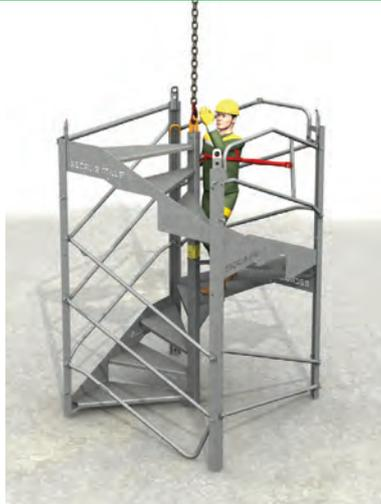
> **2** - Accès dans le module pour accrocher l'élingue sur l'anneau central, garde-corps en position fermée et lisse de montage en position horizontale.
