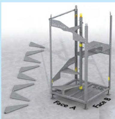
> ❶ - Mettre à niveau l'embase. Celle-ci sert de gabarit. Repérer les faces sur l'autocollant. Assembler les montants, les limons et les marches sans serrer les boulons complètement.
