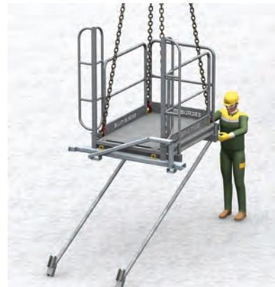
> **3** - Elingage de la passerelle latérale. Pose des bracons à hauteur d'homme avec les boulons M14-100-8.8.
