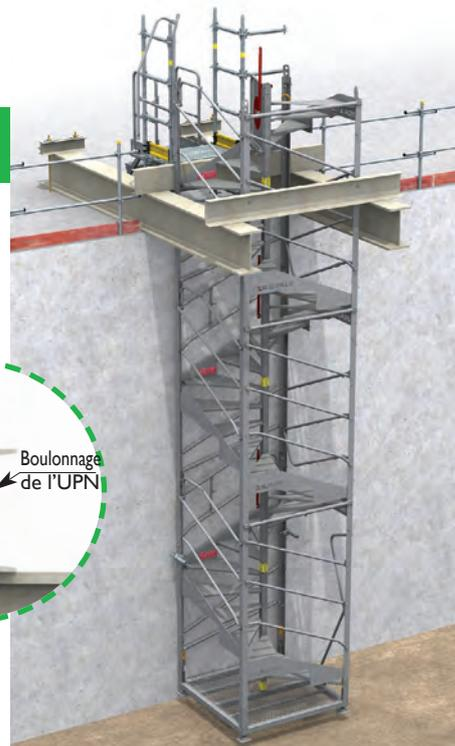
Schéma d'un Escalib Mills MDS suspendu pour accéder au fond de fouille.
