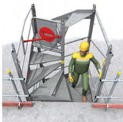
> **6** - S'assurer que les amarrages sont installés avant le décrochage des élingues. Basculement des garde-corps pour permettre la sortie au niveau souhaité.
